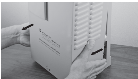
Figure 5 - Tirer sur le bas du couvercle
