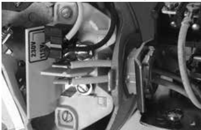
Figure 9 : Tension réglée à 115 V sur sélecteur à fiche
