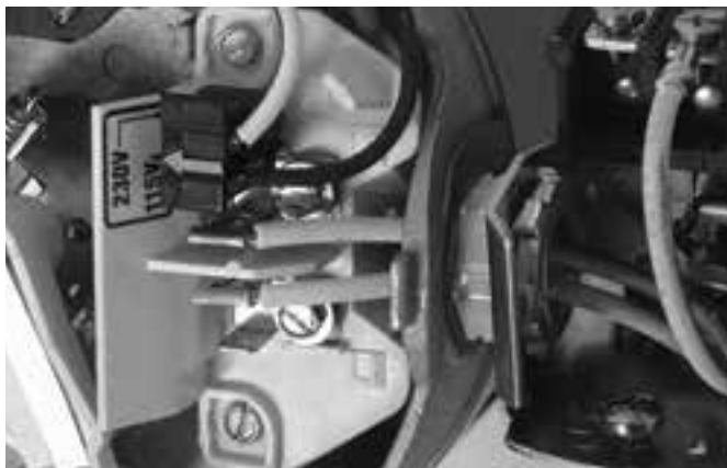
Figura 9: Tensión configurada para 115 V, tipo ficha.
