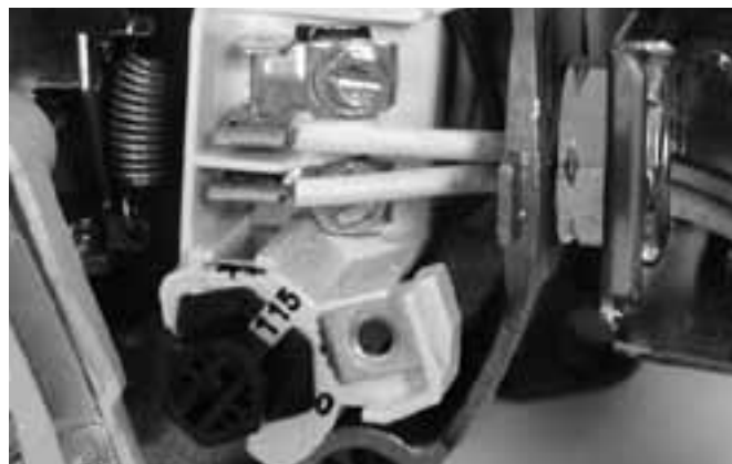
Figura 11: Tensión configurada para 115 voltios, tipo cuadrante.
