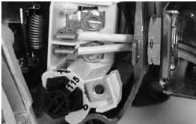
Figura 7: Tensión configurada para 115 voltios, tipo cuadrante.
