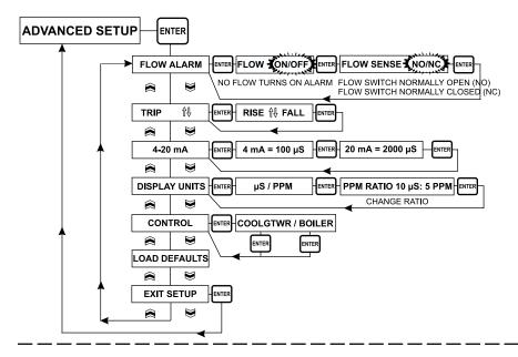
NOTE: THE BOILER MODE MUST BE SELECTED IN THE ADVANCED MENU (UNDER CONTROL).
