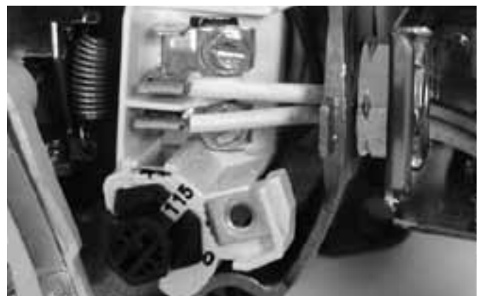
Figure 11 : Tension réglée à 115 volts sur sélecteur à cadran
